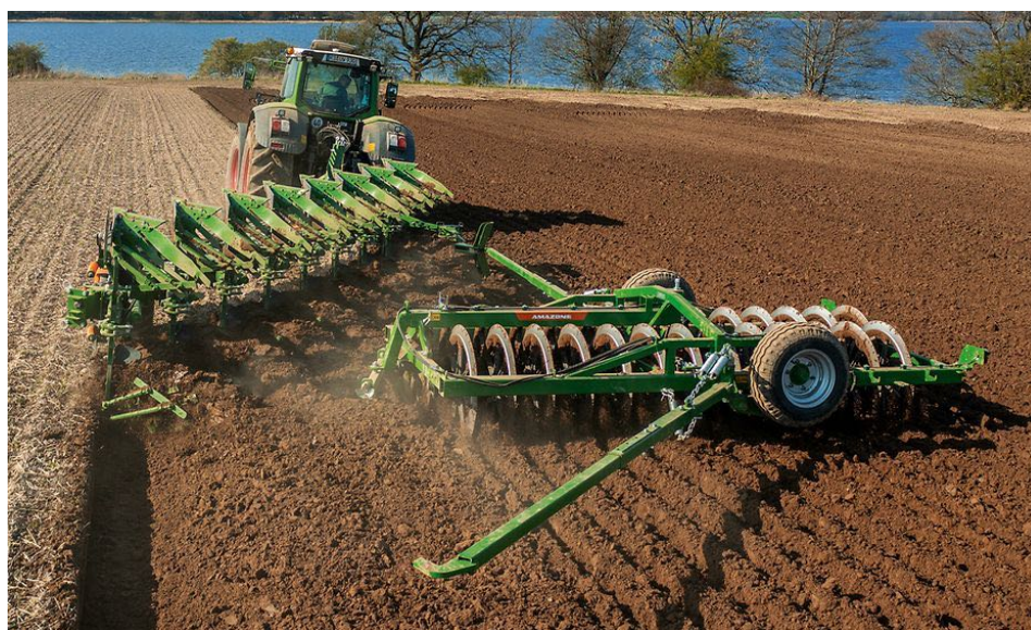
Рис.3. Плуг Tyrok 400 OL 7+1 100 с рабочей шириной, 2,8 м, требуемой мощностью трактора от 320 л.с.
