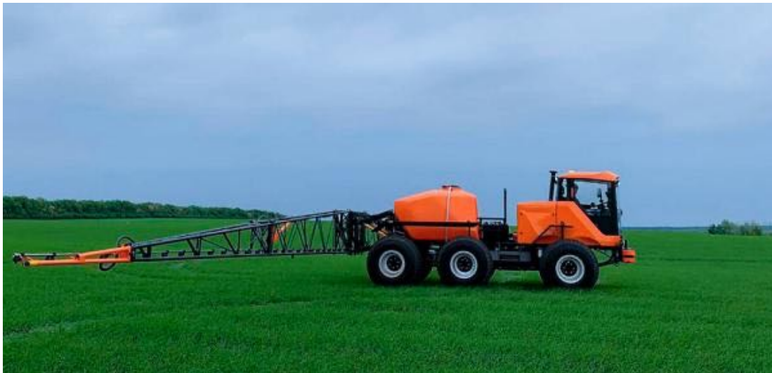
Рис.2. Штанговый опрыскиватель «Туман-3» ООО «Пегас-Агро»
