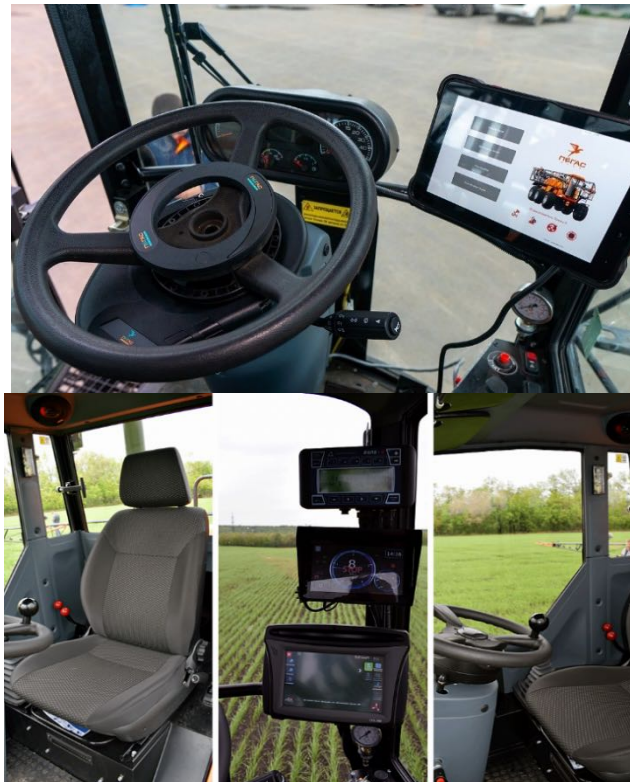
Рис.3. Оборудование в кабине «Туман» для автоматизации управления
