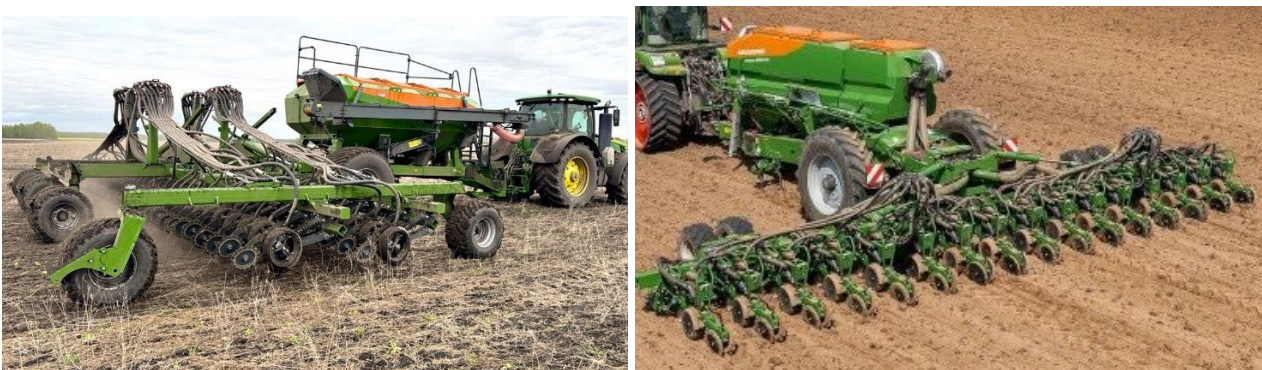
Рис.2. Работа Amazone Discara при посеве по стерне по технологии Mini-Till и по традиционной технологии
