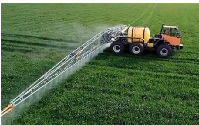
Рис.1. Комплекс «Туман-2»: а)-штанговый, б)-вентиляторный опрыскиватели
